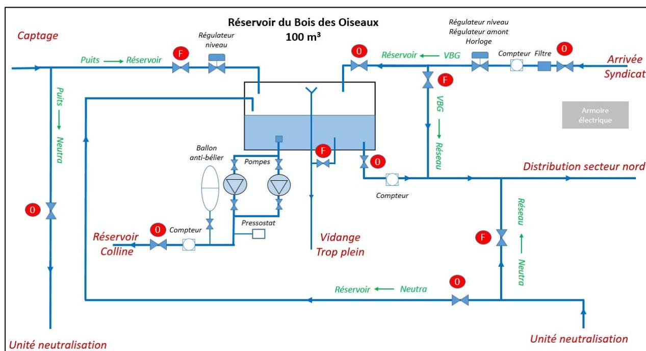
Figure 6 : exemple de schéma fonctionnel d'un réservoir
