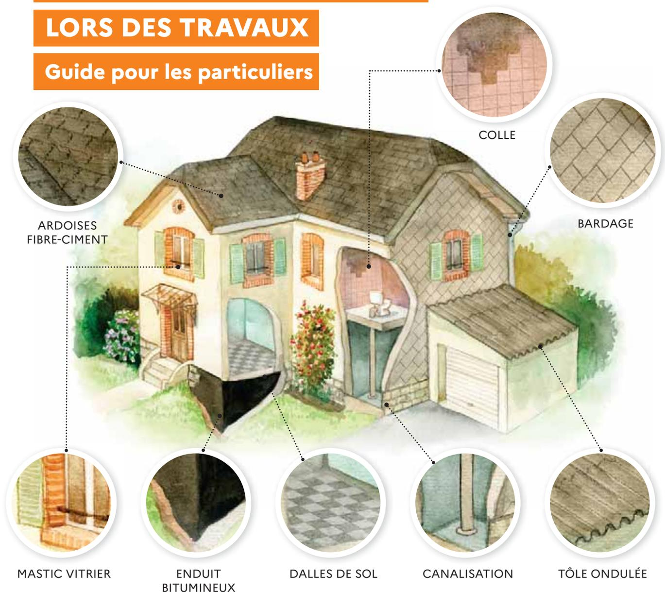
L'amiante a été interdit en 1997 mais reste aujourd'hui présent dans de nombreux composants de bâtiments construits avant cette date : toiture en ardoise artificielle, tôle ondulée, canalisations, dalle de sol en vinyle...
