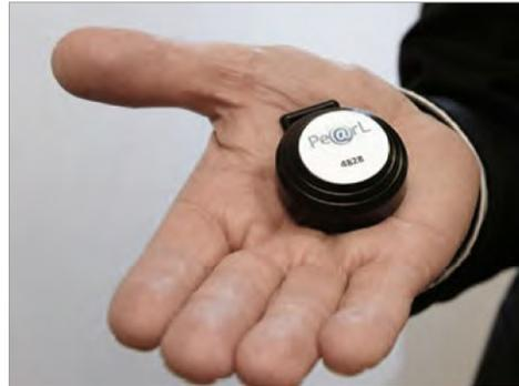
Figure 1 - Exemple de dosimètre passif (source : CLCV)
