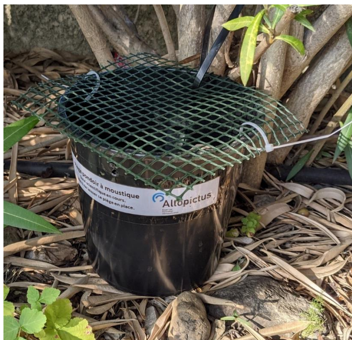
FIGURE B : PIEGE PONCHOIR AMELIORE EN 2021 AVEC UNE GRILLE ET UN COLLIER DE SERRAGE.
