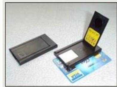
Les détecteurs de radon fonctionnent grâce à un film photosensible aux particules alpha émises par le radon et ses descendants.
